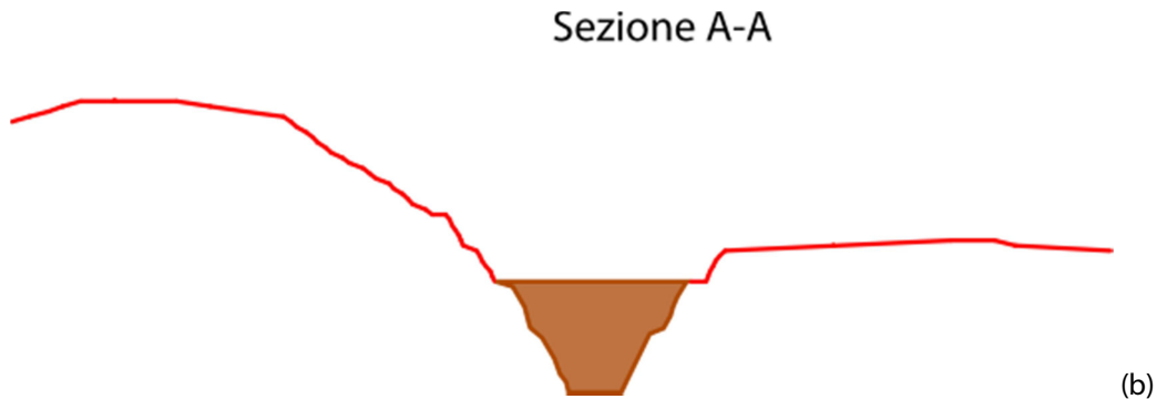
Figura 10 : rinterro parziale dei fronti occidentali di miniera. Vista in pianta (a) e sezione tipo (b).
