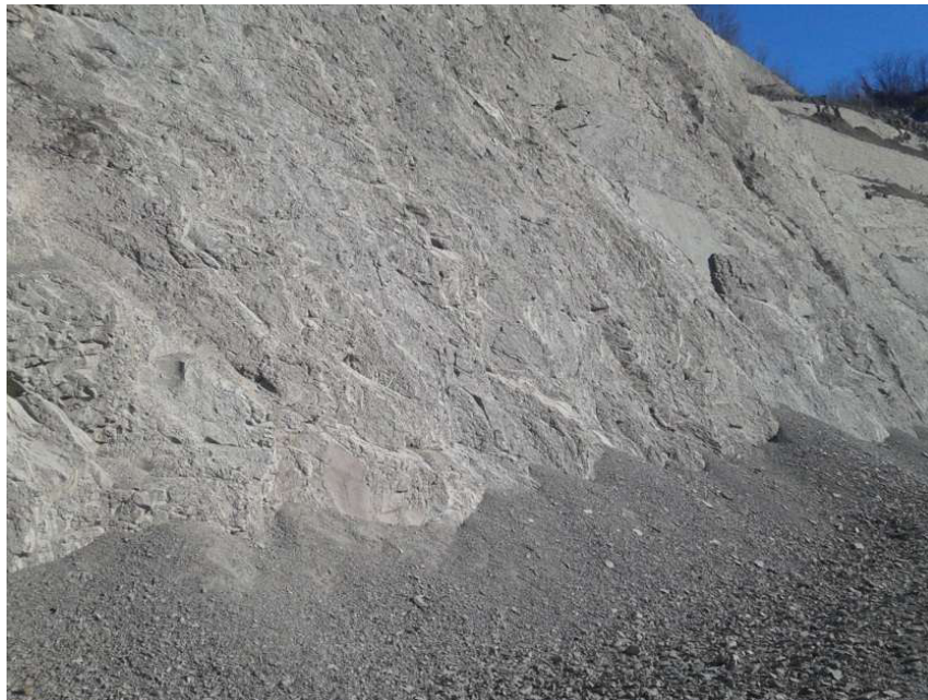
Figura 13: strato di roccia alterata e degradata rilevato sugli attuali fronti di scavo.
